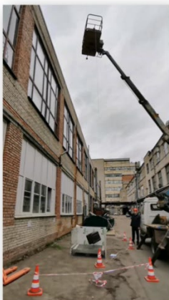
Испытание: падение с 9 метров
