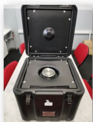
УКТМІА-РТ перед испытанием на падение с 9 метров
