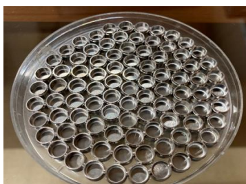
Партия корпусов из монель-металла с бериллиевыми окнами для источников GBa3.06
