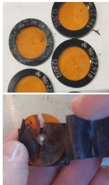
Рисунок 4. Поврежденные источники ОСГИ-РТ и разрушенный источник ОСГИ-П
